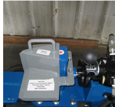
Coin en croix avec boulon de retenue en U pour WE230
