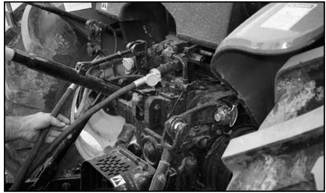
Fig. 16 – Premier circuit hydraulique
