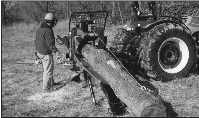
Fig. 34 – Poussez la première bille avec la bille suivante
