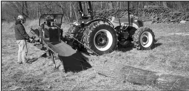
Fig. 28 – Treuillage de la première bille
