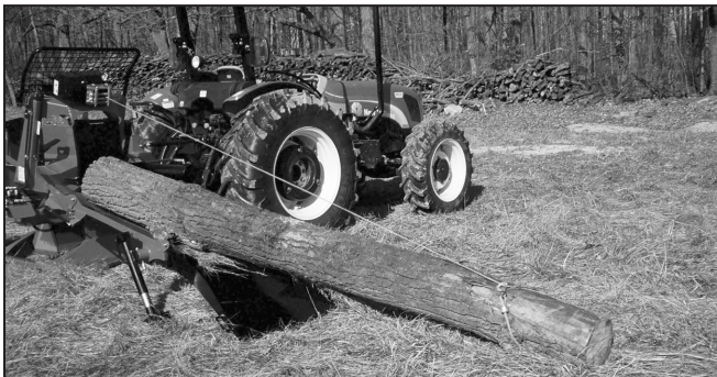
Fig. 29 – Fixez à nouveau l'extrémité éloignée
