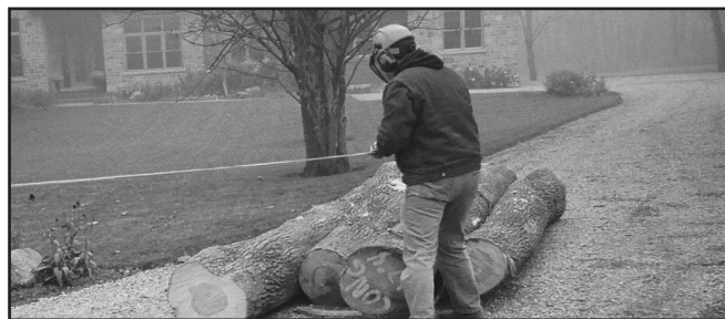
Fig. 26 – Fixation du collier étrangleur ou de la sangle
