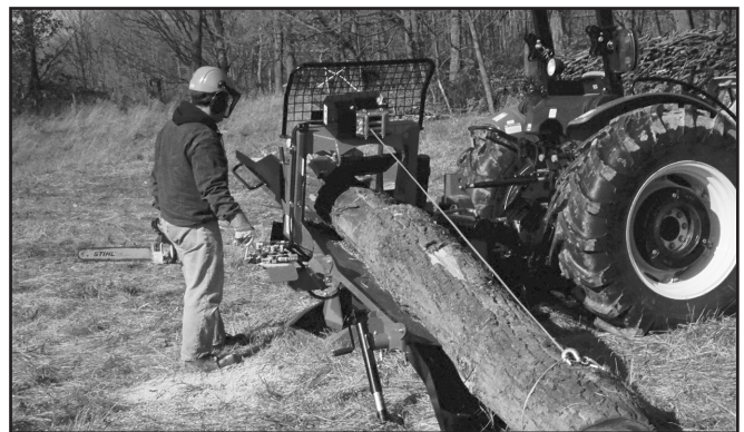
Fig. 30 – Déplacez la sangle jusqu'à l'extrémité de la bille
