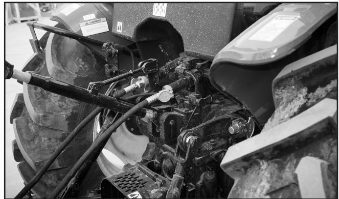
Fig. 16 – Deuxième circuit hydraulique
