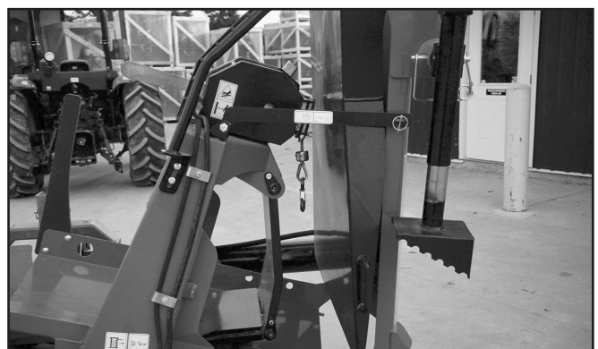
Fig. 38 – Bras de verrouillage de la goulotte d'amenée
