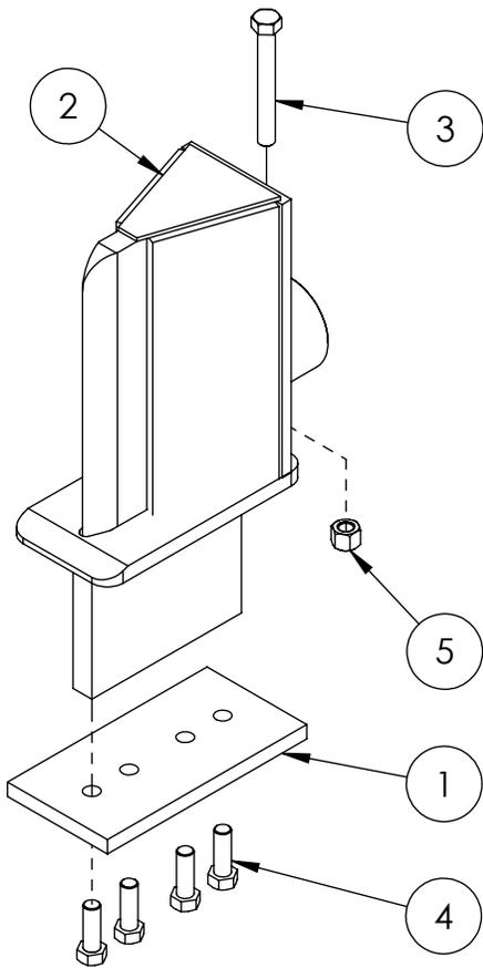
**2032A202 SLIDING WEDGE PARTS BREAKDOWN**
