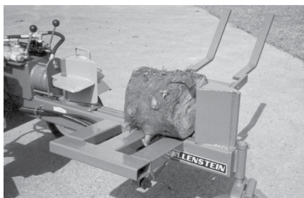
Dispositif en position haute et bûche positionnée Fig. 13 SOULÈVEMENT DES BILLES DE BOIS
